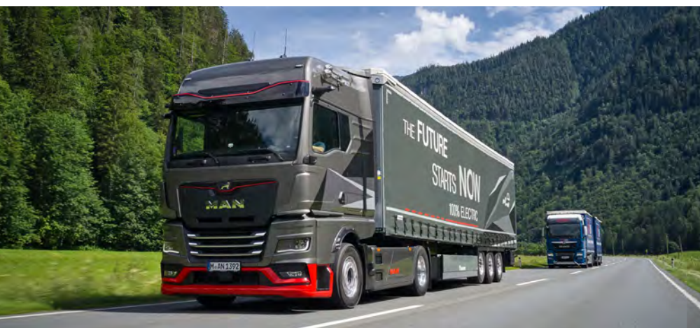
El eTruck alcanza una autonomía de 600 kilómetros, que se extenderá en 2026 hasta los 1.000 kilómetros, gracias al desarrollo de una nueva generación de baterías de alta capacidad y durabilidad; en 2025 se inicia su producción en serie.
