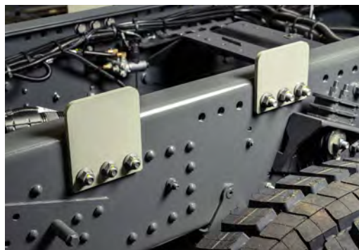
DAF cuenta con cuatro métodos de anclaje (BAM) para las carrocerías.
