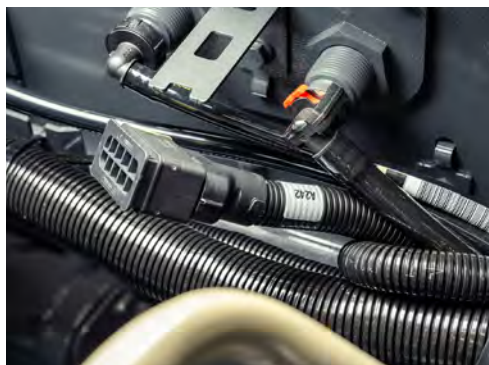
Uno de los objetivos del programa Plug and Play, DAF es evitar uno de los problemas más habituales en el proceso de carrozado: fallos en las conexiones electrónicas; arriba, detalle del panel extra para los interruptores MUX programables.
