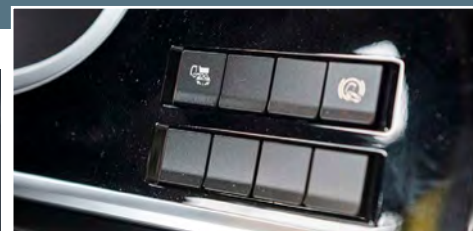
Uno de los objetivos del programa Plug and Play, DAF es evitar uno de los problemas más habituales en el proceso de carrozado: fallos en las conexiones electrónicas; arriba, detalle del panel extra para los interruptores MUX programables.
