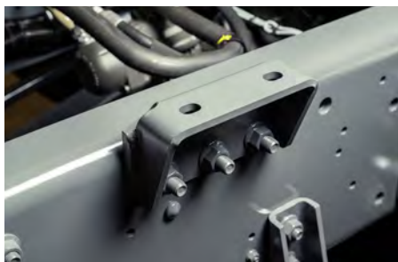
DAF cuenta con cuatro métodos de anclaje (BAM) para las carrocerías.
