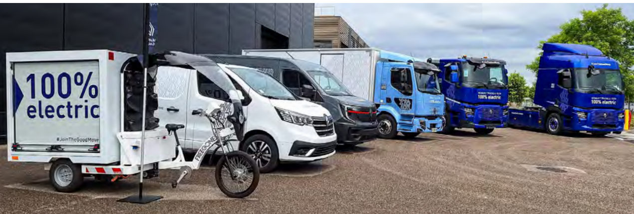
Foto de familia de los vehículos eléctricos de Renault Trucks, que cubren un rango de pesos que va de los 650 kilos de la Cargo Bike Kleuster hasta las 44 toneladas de la tractora E-Tech T.
