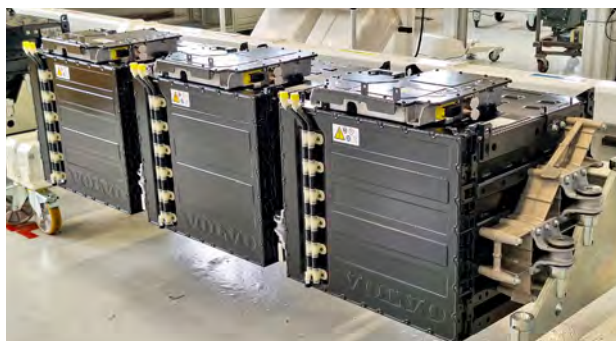
Pack de tres baterías listo para montar en una tractora Renault Trucks E-TechT.
